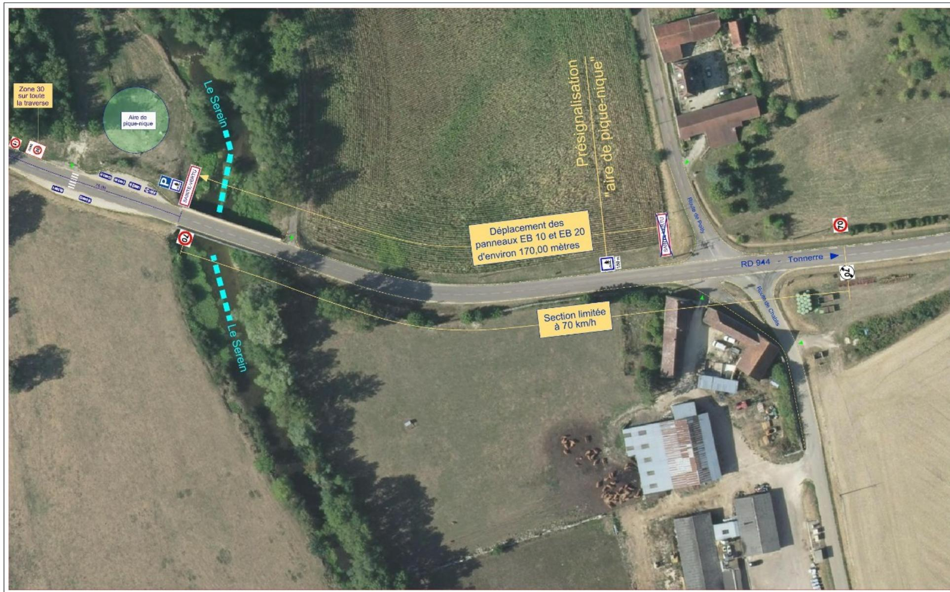
Suite à cette entrée d'agglomération et pour assurer le ralentissement des usagers avant le virage à gauche, une nouvelle écluse double est proposée (plantations basses pour ne pas obstruer la visibilité).
