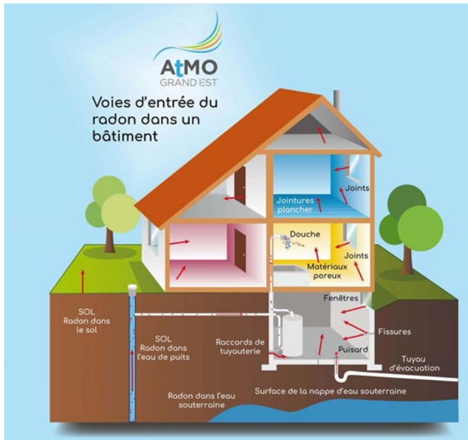
Voies d'entrée du Radon dans les bâtiments
